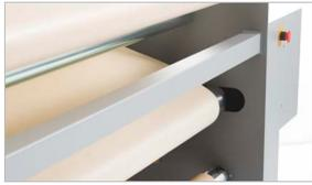
Tappeto in feltro di alta qualità con sistema di centraggio automatico
