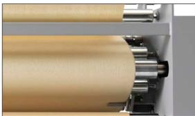
Esclusivo cilindro ad olio che permette di lavorare anche con resistenze daneggiate
