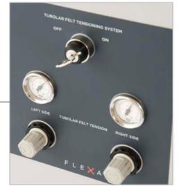
Regolazione pneumatica della tensione del tappeto in feltro, indipendente a destra e a sinistra
