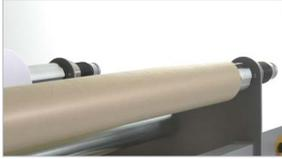
6 alberi porta-bobine: 3 riavvolgitori motorizzati con frizione e tre svolgitori con freno
