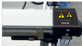
Struttura portante in alluminio e acciaio con staffe di fissaggio
