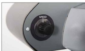
Regolatore della velocità di taglio (max. 100 m/min.)
