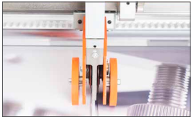
Coltello longitudinale a lama rotante singola con cuscinetto (lama doppia optional)
