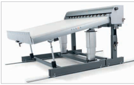
Coltello longitudinale a lama rotante singola con cuscinetto (lama doppia optional)
