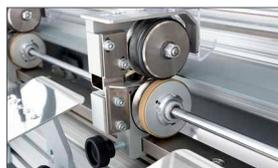
Coltelli longitudinali a forbice motorizzati (lama doppia optional)
