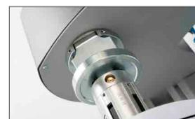
Facilità di carico delle bobine pesanti grazie all'albero di espansione ad aria
