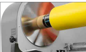
Sistema di chiusura del mandrino con controllo pneumatico per bloccare le bobine sull'albero
