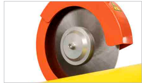
Lama a doppio bisello (standard). Lama a singolo bisello (optional) per il taglio di tessuti e rotoli di piccole dimensioni
