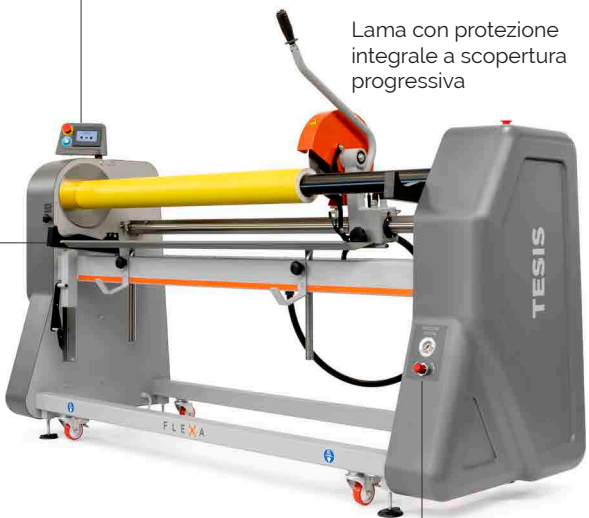
Regolazione pressione di avvicinamento contropunta
