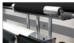
Supporto intermedio regolabile (uno per Tesis 3300, due per Tesis 5100) per sostegno bobine/albero durante le operazioni di taglio (optional)
