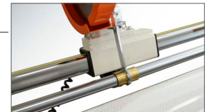
Scorrimento facilitato dell'unità di taglio su asta cromata Ø 50 mm con bloccaggio manuale
