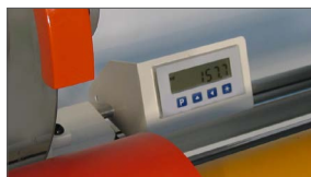
Visualizzatore digitale delle quote di taglio
