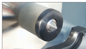
Sistema di chiusura del mandrino con controllo pneumatico
