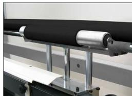
Supporto intermedio regolabile (uno per Tesis 3300, due per Tesis 5100) per sostegno bobine/albero durante le operazioni di taglio (optional)
